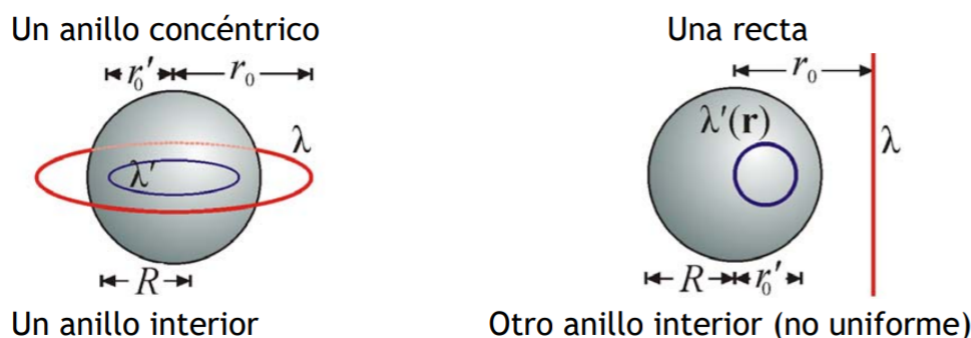
Figura 4.10: Método de las imágenes para dos distribuciones continuas diferentes y una esfera.
